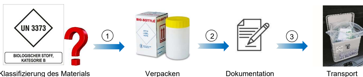
Abbildung 1: Schematische Darstellung zur Ermittlung der richtigen Verpackungs- und Transportart für biologisches Probenmaterial [1-3].
